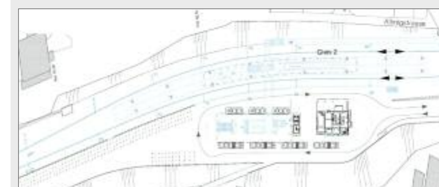
4. Etappe, September bis Dezember 2011: Der Mittelperron, die Gleise 1 und 2 sowie die Unterführung werden in Betrieb genommen. Jetzt wird der Bushof gebaut. Beim Bahnbetrieb gibt es keine Einschränkungen mehr.
