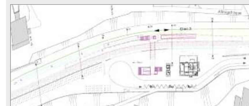
2. Etappe, März bis Juni 2011: Das jetzige Gleis 3 wird abgebrochen. Deshalb kreuzen die Züge in Immensee. Es entsteht ein provisorischer Mittelperron, dessen Einstieg ist in Richtung Luzern versetzt.
